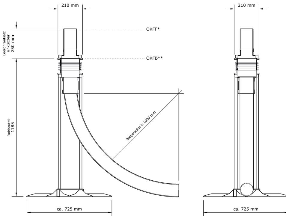
OKFF\* = Oberkante Fertigfußboden, OKFB\*\* = Oberkante Rohfußboden
